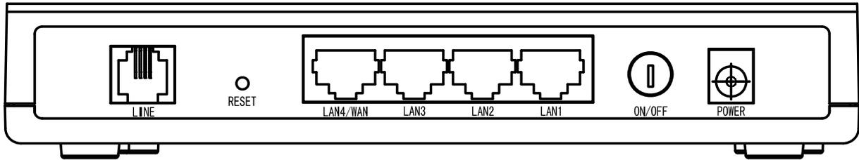
图 2 TD-89410 后面板示意图
